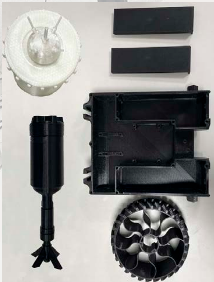
Piezas de simulación (izquierda) y del robot «Caronte» (derecha) realizadas con la impresora 3D
