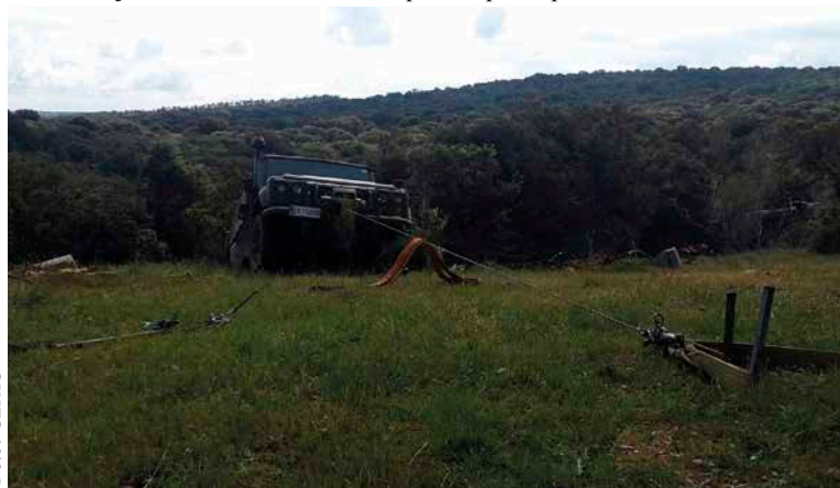
Foto inferior: uso del cabestrante para superar pendientes
