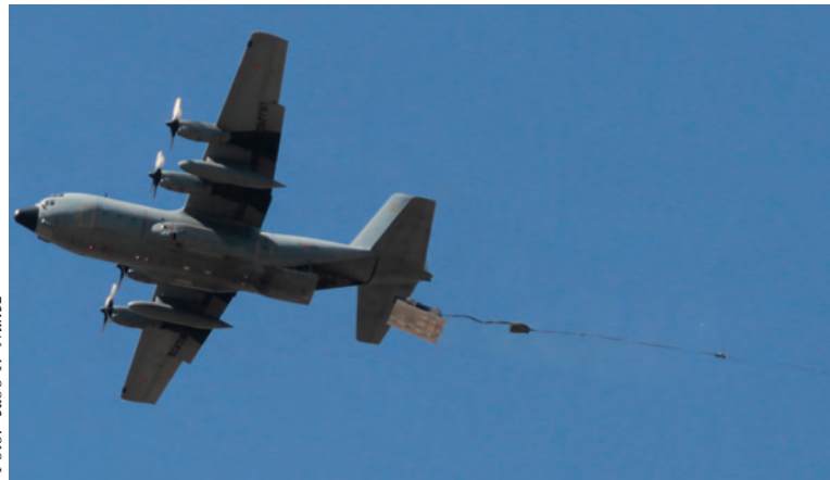
El paracaidas extractor saca el mistral del avión
