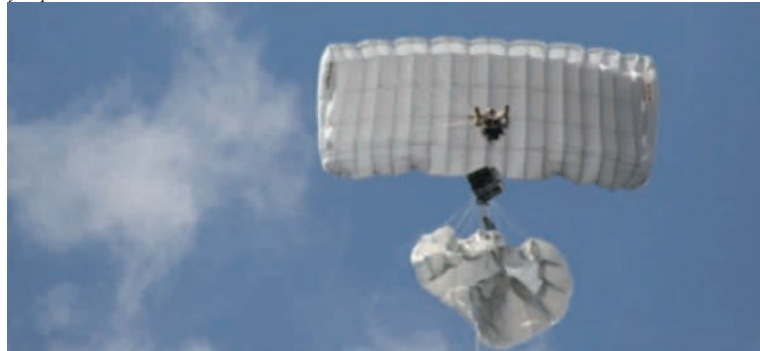
Foto inferior: el paracaidista libera el HCC lo que abre el paracaídas de la carga y le permite tomar tierra libremente
