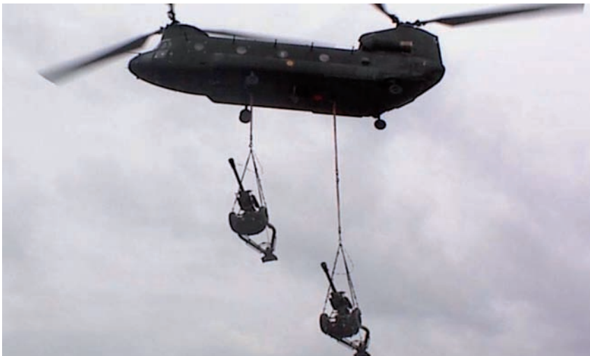
Vista externa de la carga de dos obuses L-118 en un HT-17 “Chinook”
