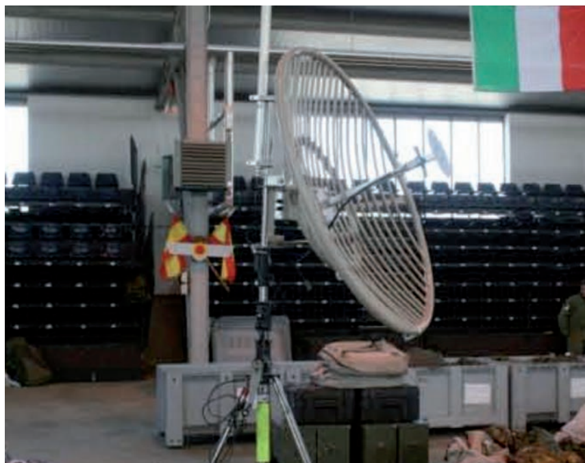
Antena receptora del sistema de posicionamiento usado por el personal italiano
