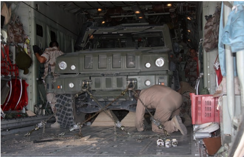
Estado de un LMV "Lince" para su aerotransporte en T-10
