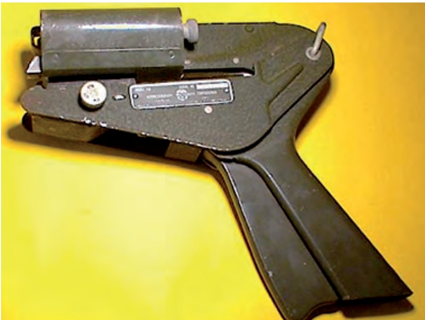
Maquina para transferir los datos de la chapa de identificación al informe de fallecido
