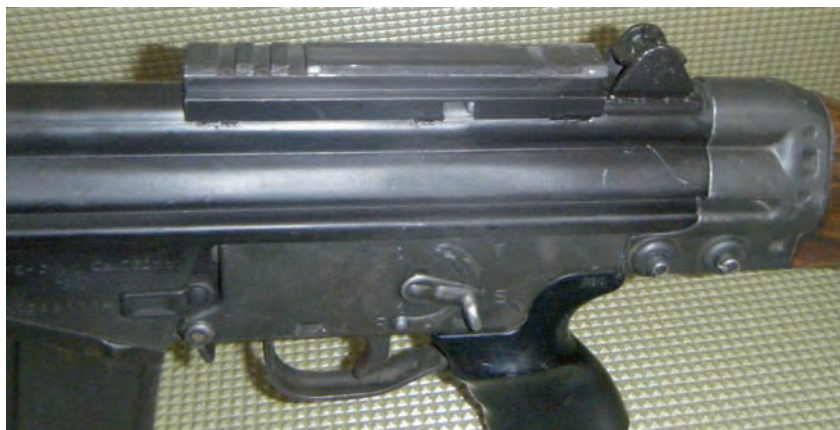
Guía picatinny soldada sobre el cajón de mecanismos del CETME “C”
