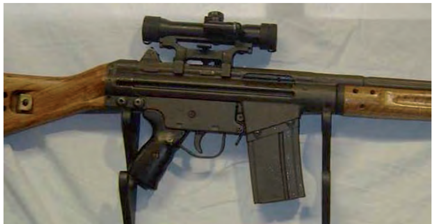
CETME C con montura alta y visor de 4 aumentos
