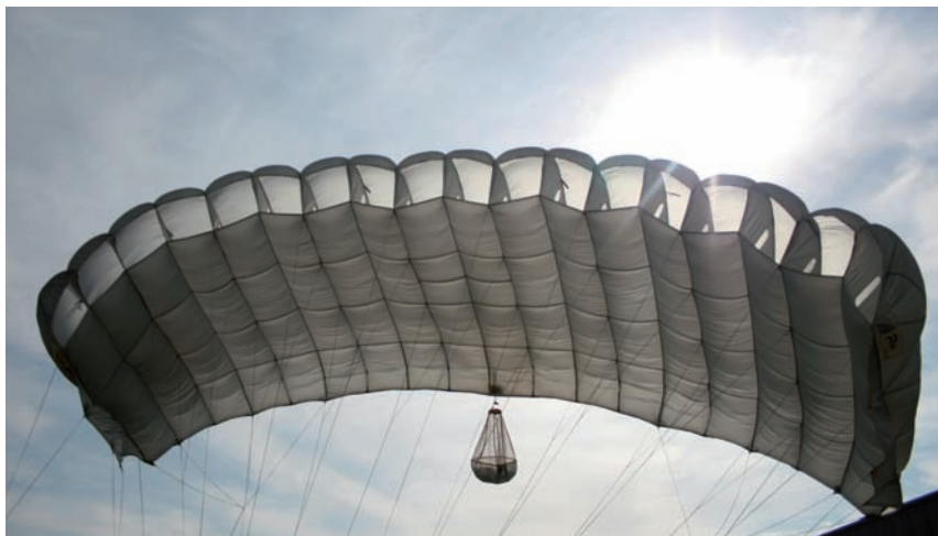
El tamaño de la campana es el otro dato necesario para el cálculo de la carga alar.
