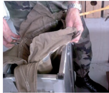
Plegado del EPC usando una caja de aluminio
