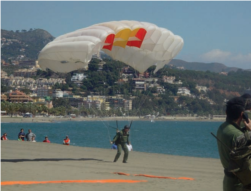
Los paracaídas deportivos, debido a sus necesidades de manejo, precisión y a su comportamiento más predecible, tienen siete celdas
