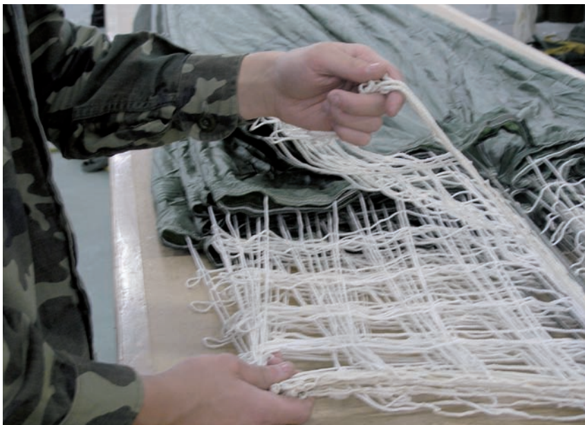
Un momento del plegado de un paracaídas TP-2B
