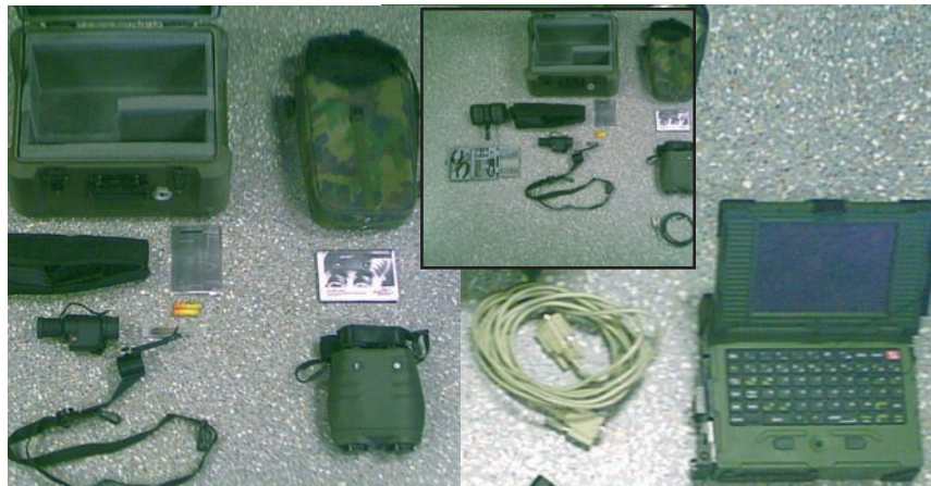
Diferentes elementos del sistema CATAL: Telémetro. PDA y ordenador ruggedizado para los FDC,s.
